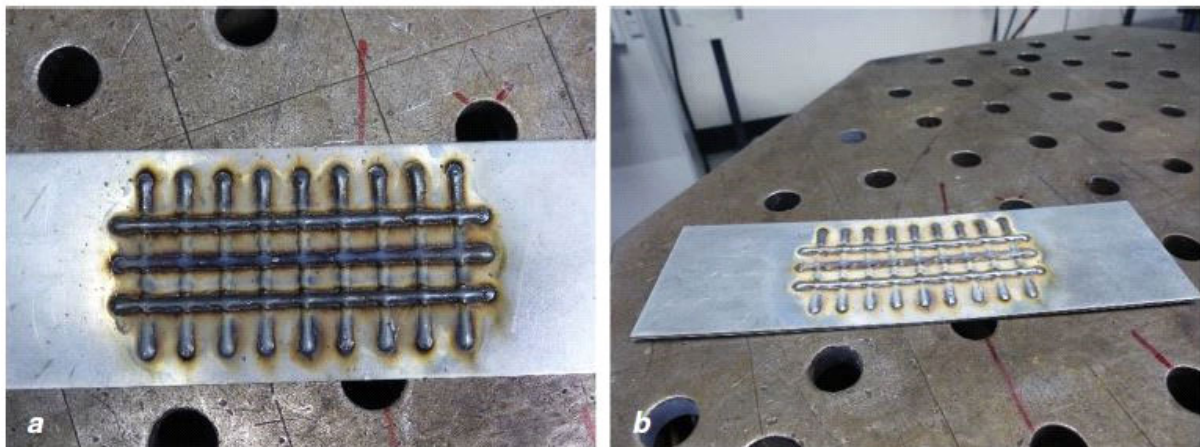
Bild 8 a, b: Schweißergebnisse der additiven Herstellung eines Gitters auf verzinktem Stahlblech von 2 mm Dicke: Drei Muster für den Biegeversuch: ohne Gitter (a), orthogonales Gitter (b), diagonales Gitter (c)
