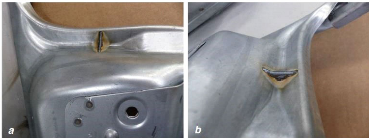
Bild 10 a, b: Schweißergebnisse der additiven Herstellung eines Knotenblechs im Karosseriebereich von 0,7 mm Dicke
